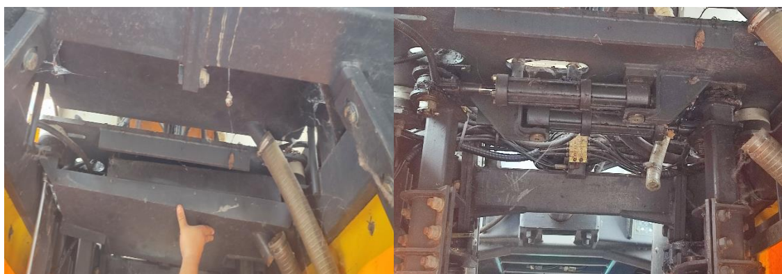
29. Ábra. Munkahengernek védő tárcát, és defektes munkahenger.
