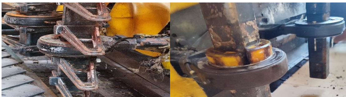
33. Ábra. Defektes kúpgörgős csapágy, és javított kúpgörgős csapágy.
