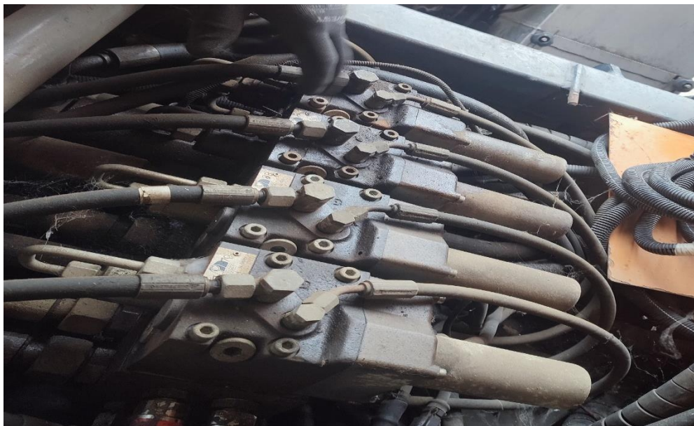
34. Ábra. Elkopót hidraulikus vezérlőtömb.
