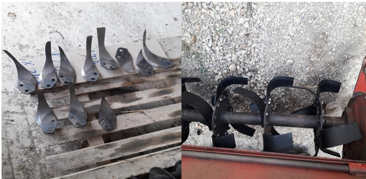
23. Ábra. Elkopót talaj maró, és vissza szerelt új talaj maró.
