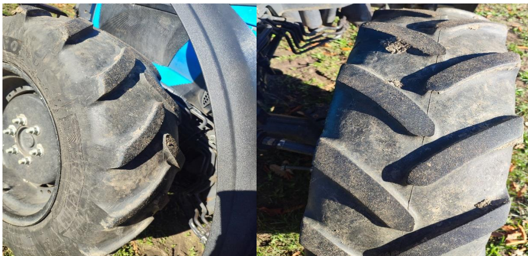
24. Ábra. Landini balelő kerék elkopott.
