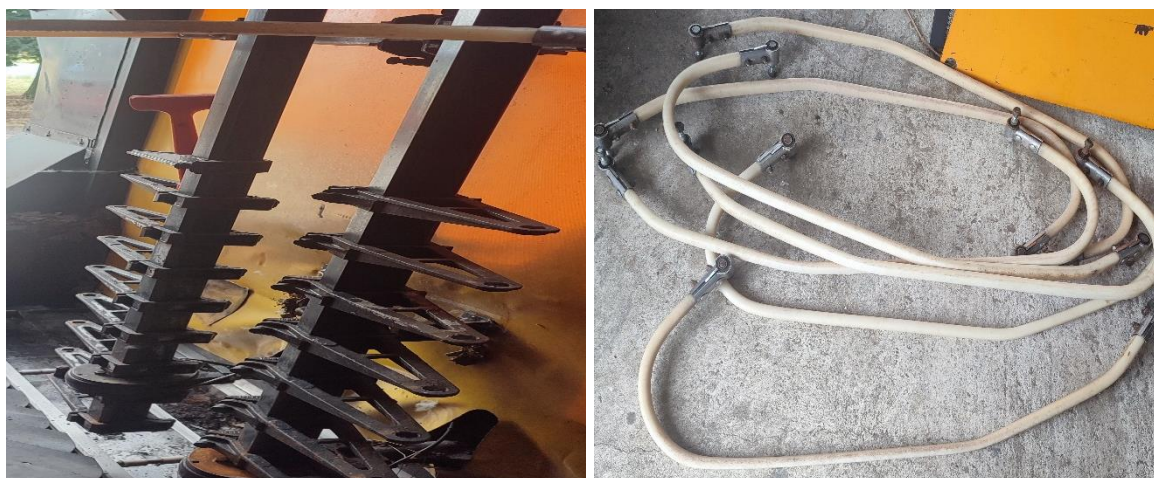
31. Ábra. Rázó mozgású rendszer, és elkopott verőléc.
