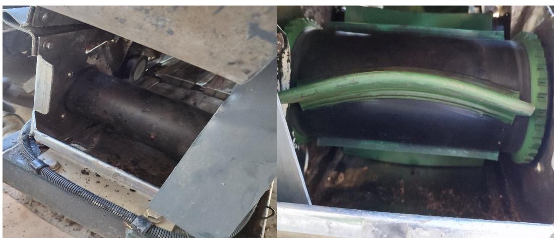
38. Ábra. Szalag hátsó görgő, és a szalag visszaállítás.
