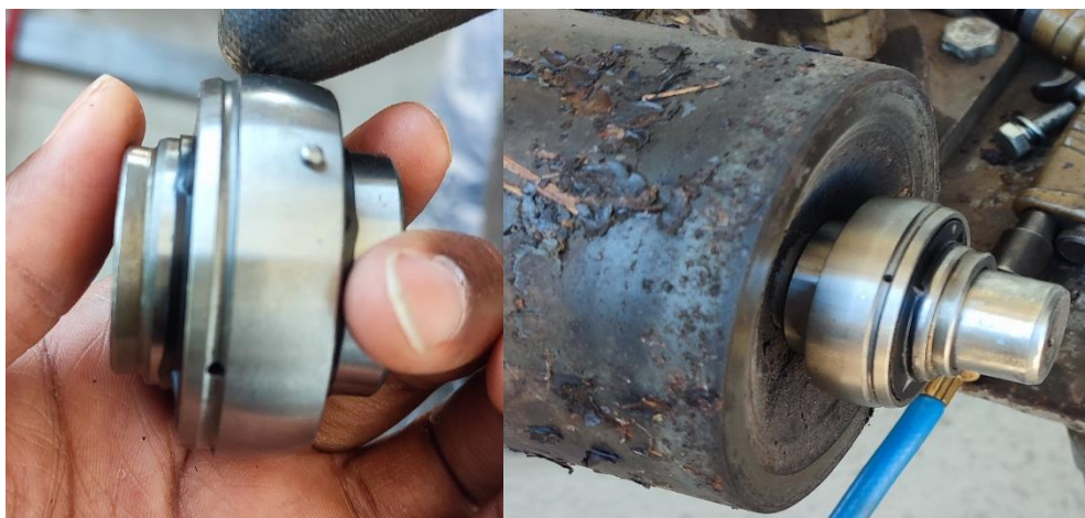
39. Ábra. A csapágyat beszereltük a hátsó görgő tengelyére.
