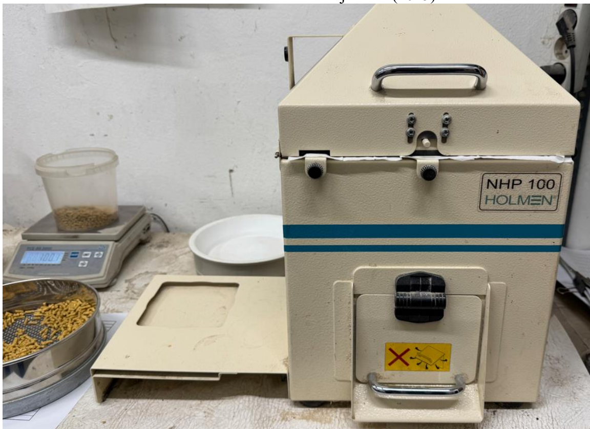
12. ábra: HOLMEN NHP 100 típusú pelletkeménység-vizsgáló berendezés laboratóriumi mérés közben Forrás: saját fotó (2025)
