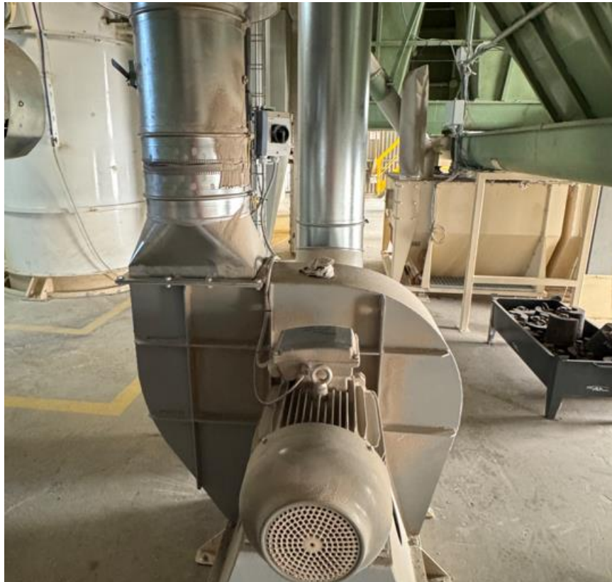
8.ábra: Kalapácsos daráló megszívó ventilátora és hajtómotorja kézi zsaluállítási lehetőséggel
