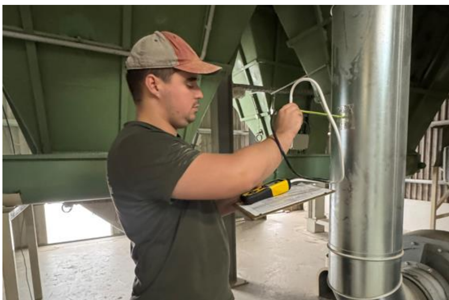
1. ábra: Pitot-csöves légsebességmérés a daráló elszívóvezetékén Forrás: saját fotó (2025)
