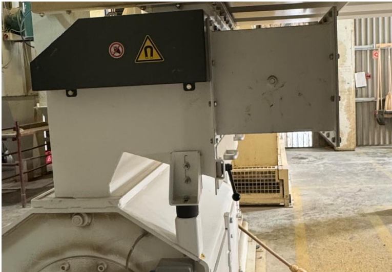
6.ábra: Kalapácsos daráló előtti mágneses idegen-test leválasztó egység Forrás: saját fotó
