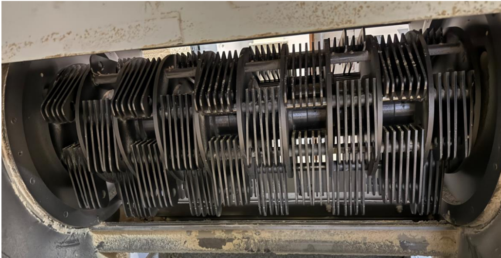
7.ábra: Amandus Kahl kalapácsos daráló rotorja és kalapácssora Forrás: saját fotó (2025)
