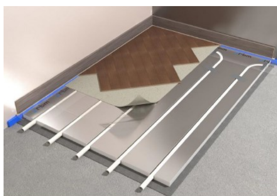
21.ábra Csőfektetés száraz eljárással (Versitsné Cz., 2000/5.lapszám)
