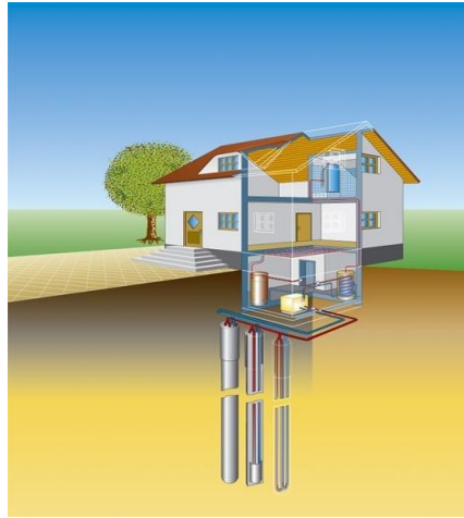
11.ábra Hőszivattyús fűtés talajszondával (Econ) (Antony F.,2009)
