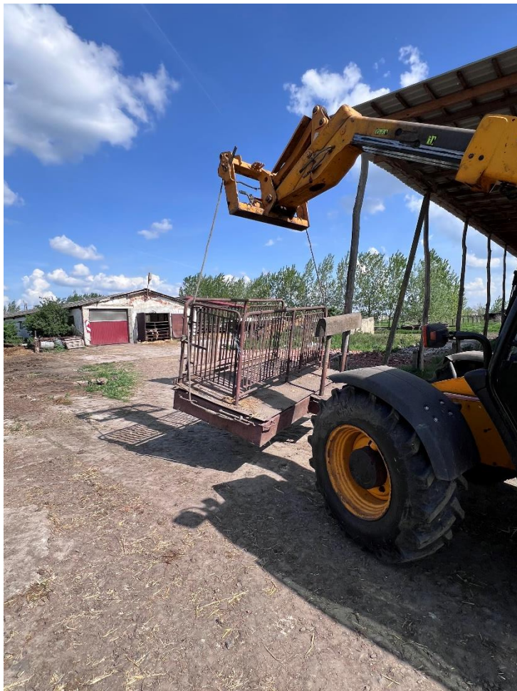
2. ábra: A mechanikus mérleg helyére rakása a mérésekhez
