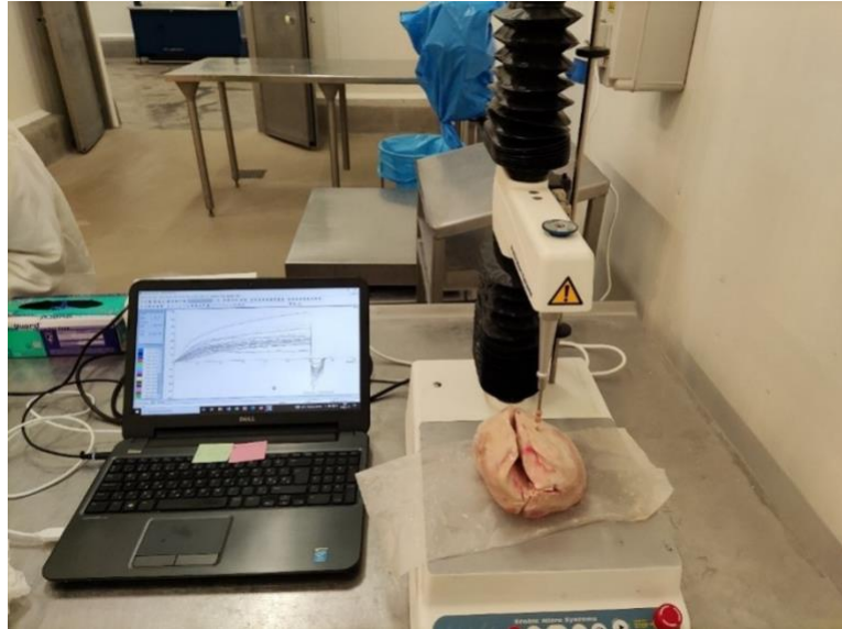
6. ábra Műszeres textúra mérés (fotó Pap Tibor István)
