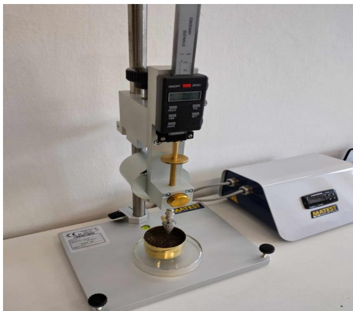
5. Ábra: A penetrométer, előkészített talajmintával.
