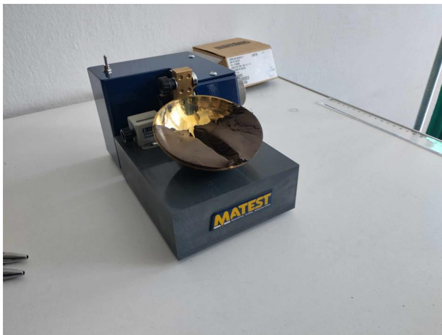
4. Ábra: A Casagrande-készülék, a benne elhelyezett talajmintával, valamint az abba húzott árokkal.
