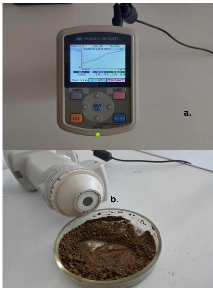
6. Ábra: A fotospektrométer kijelzője (a) és a mintákat vizsgáló optikája (b).
