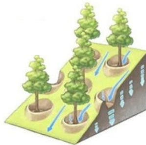
51. ábra: Mikroterasz kialakításának sematikus ábrája faegyedek körül
