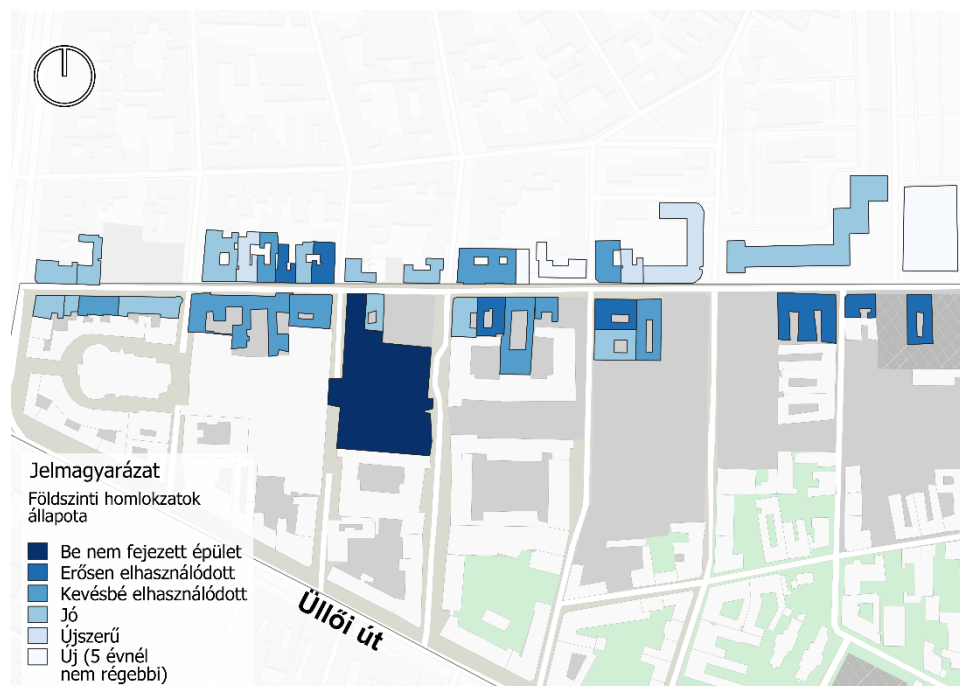
16. ábra: Földszinti homlokzatok állapota a Práter utcában 2009-ben (forrás: saját készítésű térkép)
