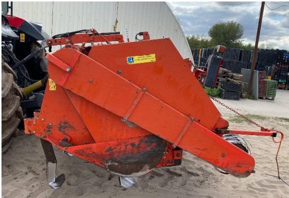
12. ábra: Tömörítő henger alsó állása Forrás: Ancsa-Molnár Gábor
