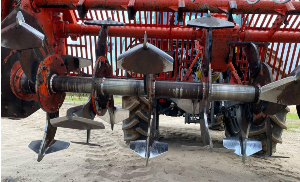
9. ábra: Ásógép művelőelemek elhelyezkedése Forrás: Ancsa-Molnár Gábor
