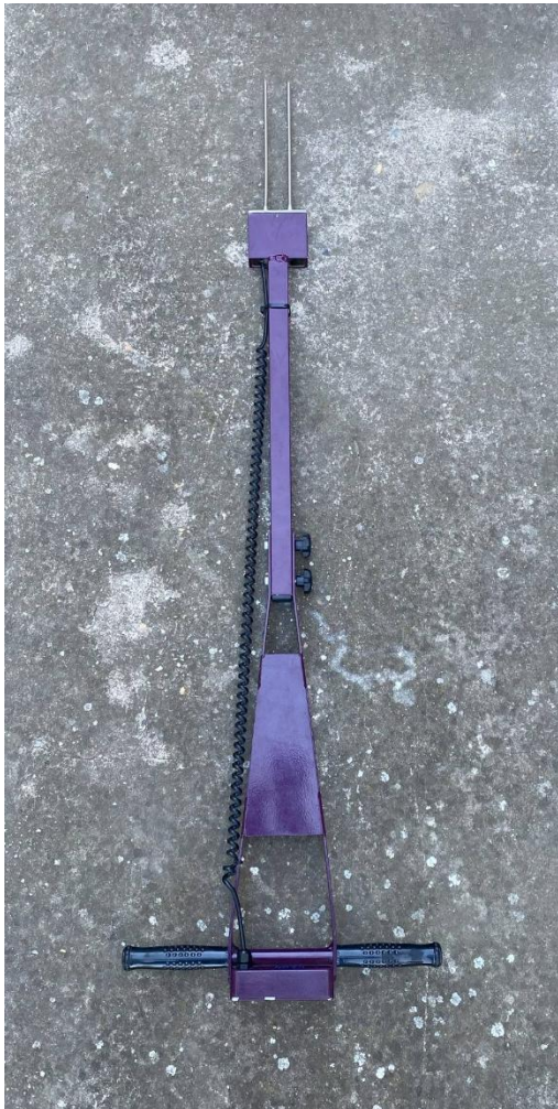
13. ábra: TDR 300 típusú tenziométer Forrás: Ancsa-Molnár Gábor
