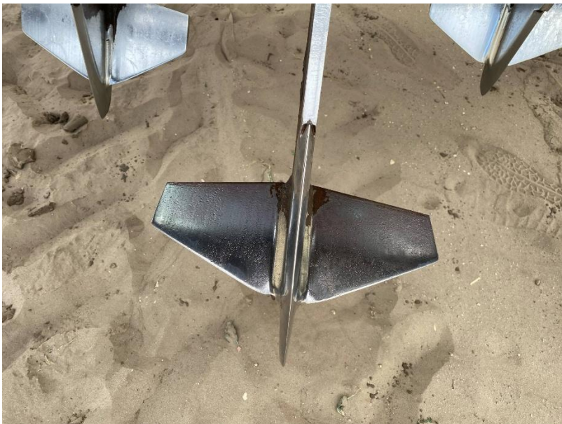
10. ábra: Ásógép művelőelem Forrás: Ancsa-Molnár Gábor
