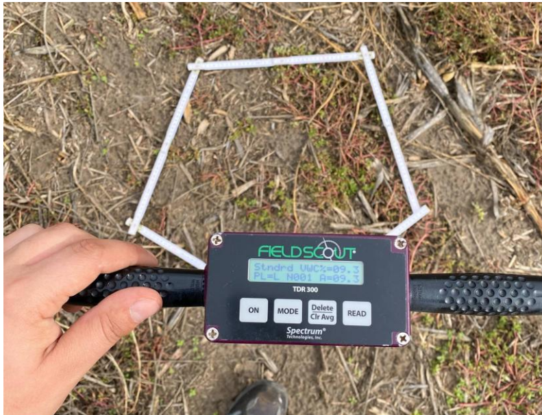
14. ábra: TDR 300 típusú tenziométer Forrás: Anca-Molnár Gábor
