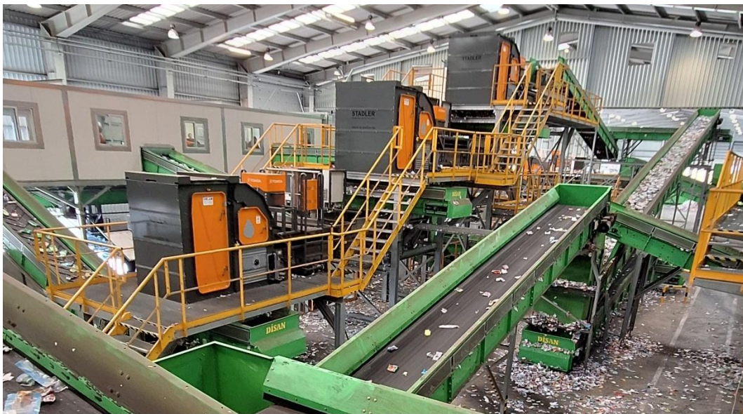
16. ábra: Szín szerinti válogatást végző optikai szeparátor egységek (Forrás: saját készítés)
