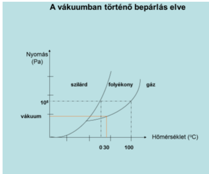
1. ábra: A vákuumban történő bepárlás elve (forrás: BARÓCSI, 2018)
