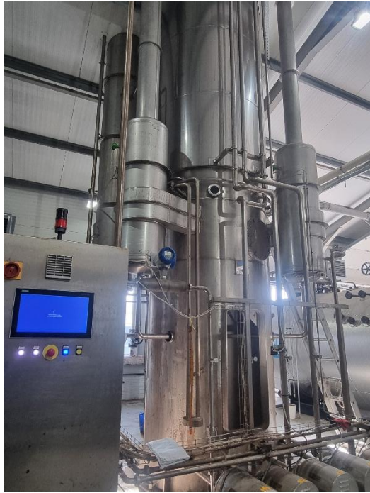
7. ábra: Vákuum bepárló berendezés
