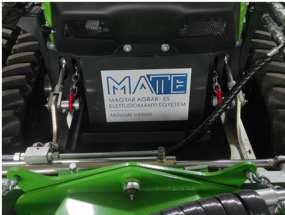
13. ábra: MDB LV 500 PRO függesztő rendszere (Forrás: Saját kép)
