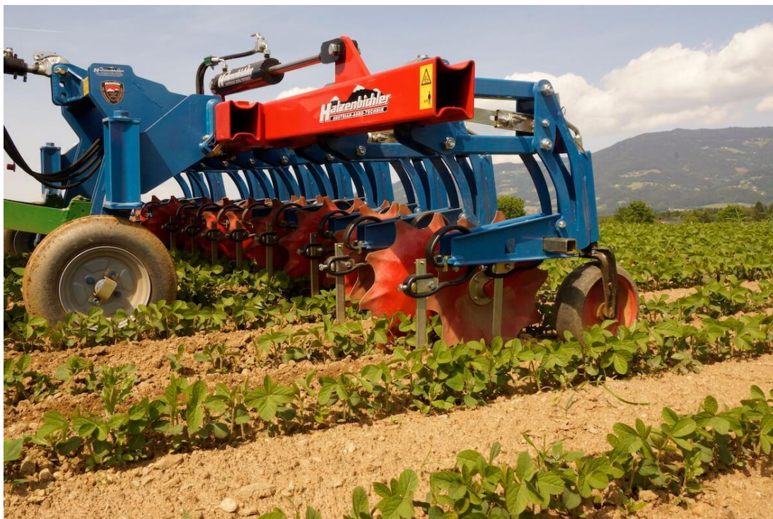
7. ábra: Hatzenbichler frontfüggesztett kultivátor művelő egységei (Forrás: https://www.hatzenbichler.com/de/fronthackmaschinen 10.25. 23:20)
