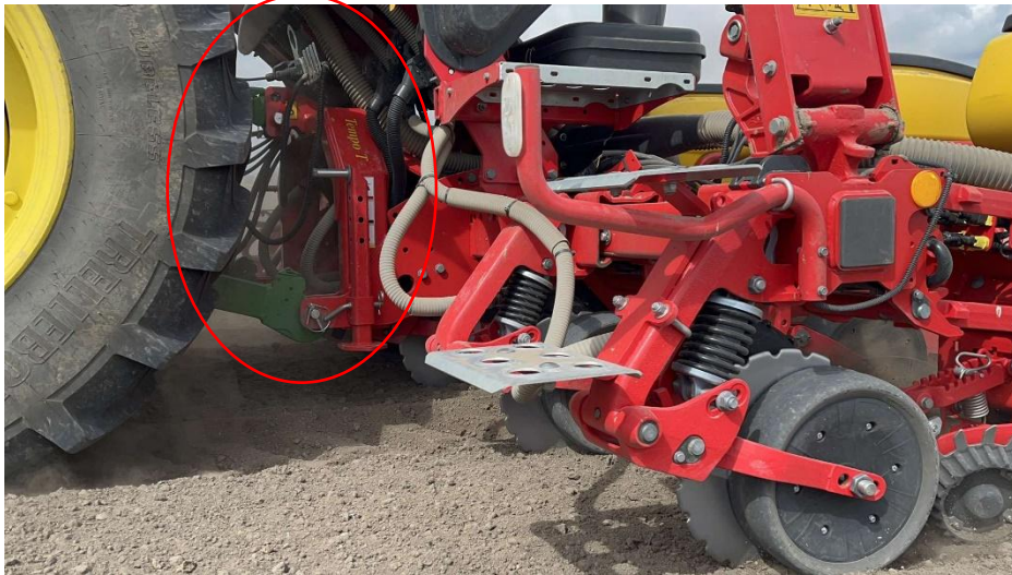
8. ábra: Erőgép és munkagép kapcsolata (Forrás: Kántor Zalán, Kántor családi gazdaság)
