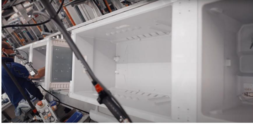
23. ábra: Beépíthető hűtőszekrény gyártás az átalakított gyártósoron (saját fotó)
