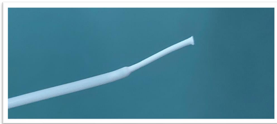
4.8. ábra: PLA filament szakadás előtti nyakasodása. Forrás: saját készítésű fénykép, MATE Gépszerkezettani Labor, Gödöllő.
