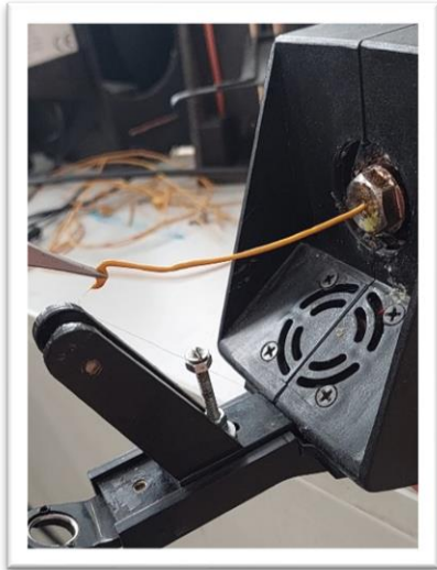
4.3. ábra: filament végének megfogása a kezdeti fázisban. Forrás: saját készítésű fénykép, MATE AGFO Labor, Gödöllő.
