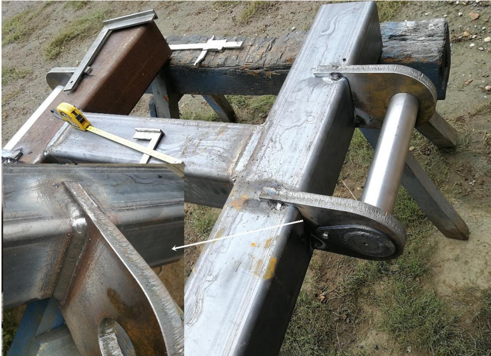
5.2. ábra - Hengersor tartó fül hegesztése
