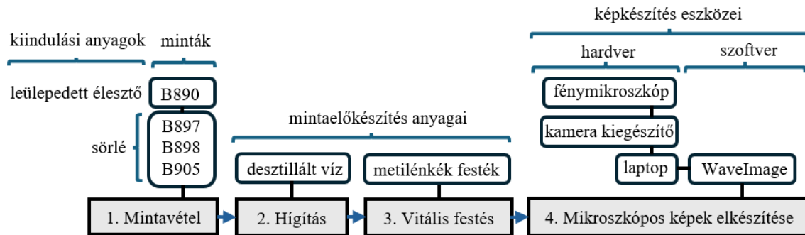
7. ábra: A mintavétel, mintaelőkészítés, illetve mikroszkópos képek elkészítésének folyamata, anyagai és eszközei (Forrás: saját munka)
