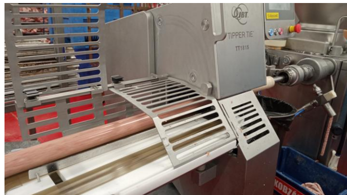
16. ábra: Béltöltés és klipszelés (Forrás: saját fotó)
