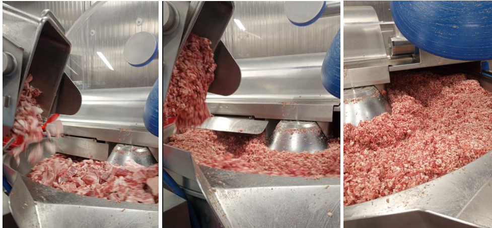
14. ábra: A kutterezés mozzanatai (Forrás: saját fotók)
