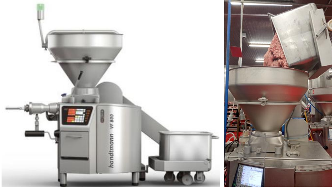
15. ábra: Handtmann vf 800 típusú töltőgép (Forrás: https://www.int.processing.handtmann.com ), A massa a garatba ömlik (Forrás: saját fotó)
