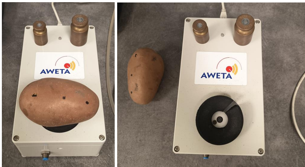
10. ábra: AWETA AFS DTF típusú roncsolásmentes laboratóriumi akusztikus- és impakt állománymérő készülék (Forrás: Saját fotó, 2025)
