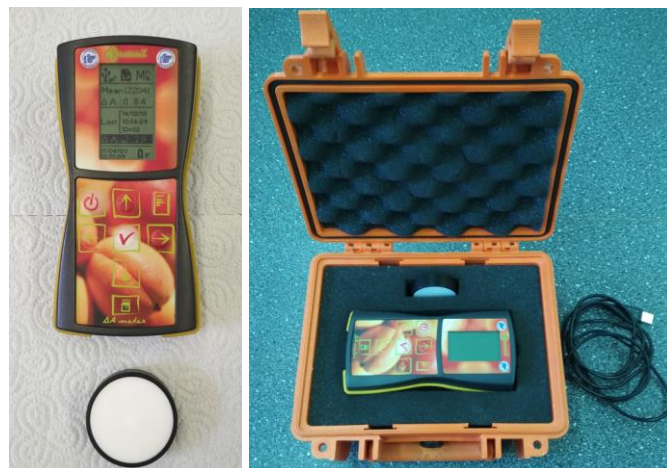
9. ábra: Sintéleia Vis/NIR DA-meter ® érettségmérő (Forrás: Saját fotó, 2025)
