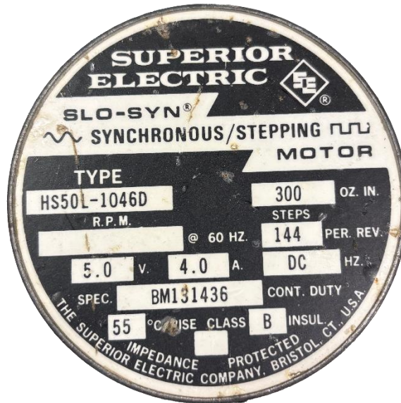
15. ábra: A léptetőmotor adattáblája
