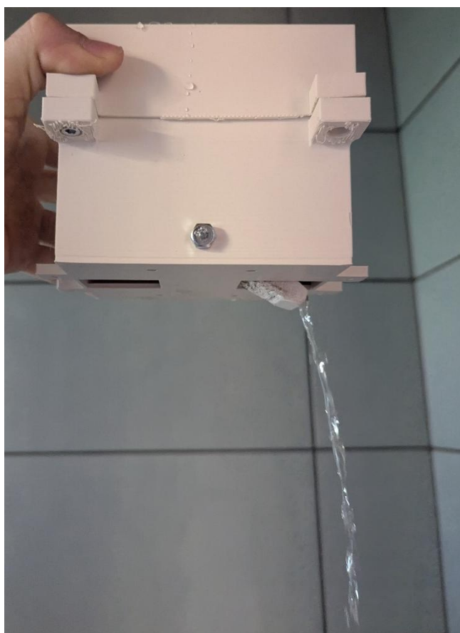
41. ábra: A csapadékmérő átfordulásának tesztelése
