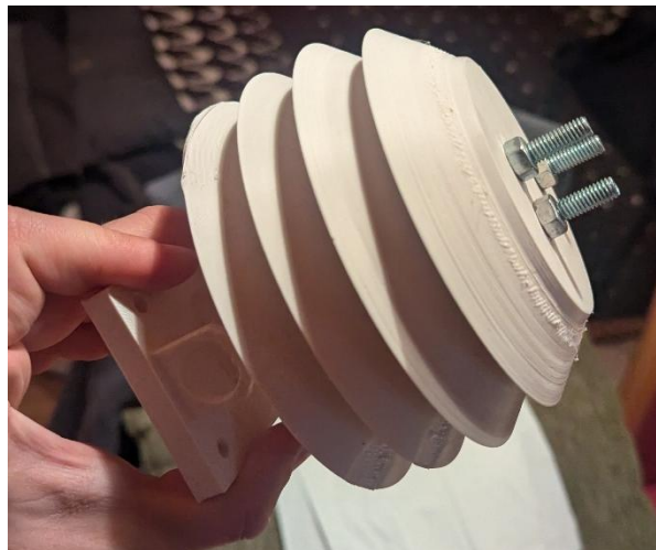
32. ábra: A legyártott hőmérséklet, páratartalom és légnyomásmérő
