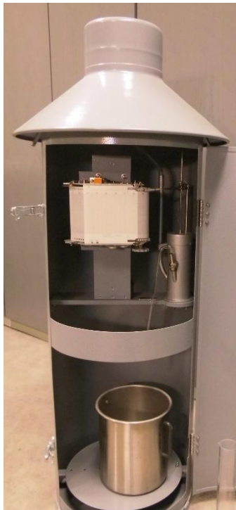
3. ábra: Hellmann-féle csapadékmérő Forrás: http://www.rfuess-mueller.de
