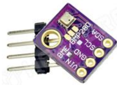
13. ábra: A BME 280-as szenzor Forrás: https://www.hestore.hu
