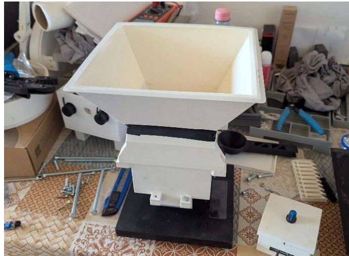
33. ábra: A legyártott csapadékmérő
