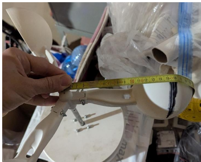
40. ábra: A szélsébségmérő forgási sugarának mérése
