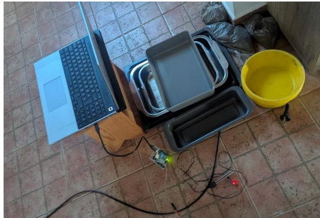
42. ábra: A talajnedvességmérő kalibrációjához használt elrendezés
