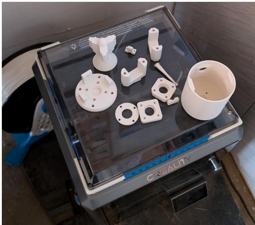
38. ábra: Az új szélességmérő alkatrészek legyártva
