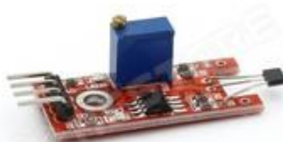
15. ábra: A felhasznált Hall-érzékelő Forrás: https://www.hestore.hu
