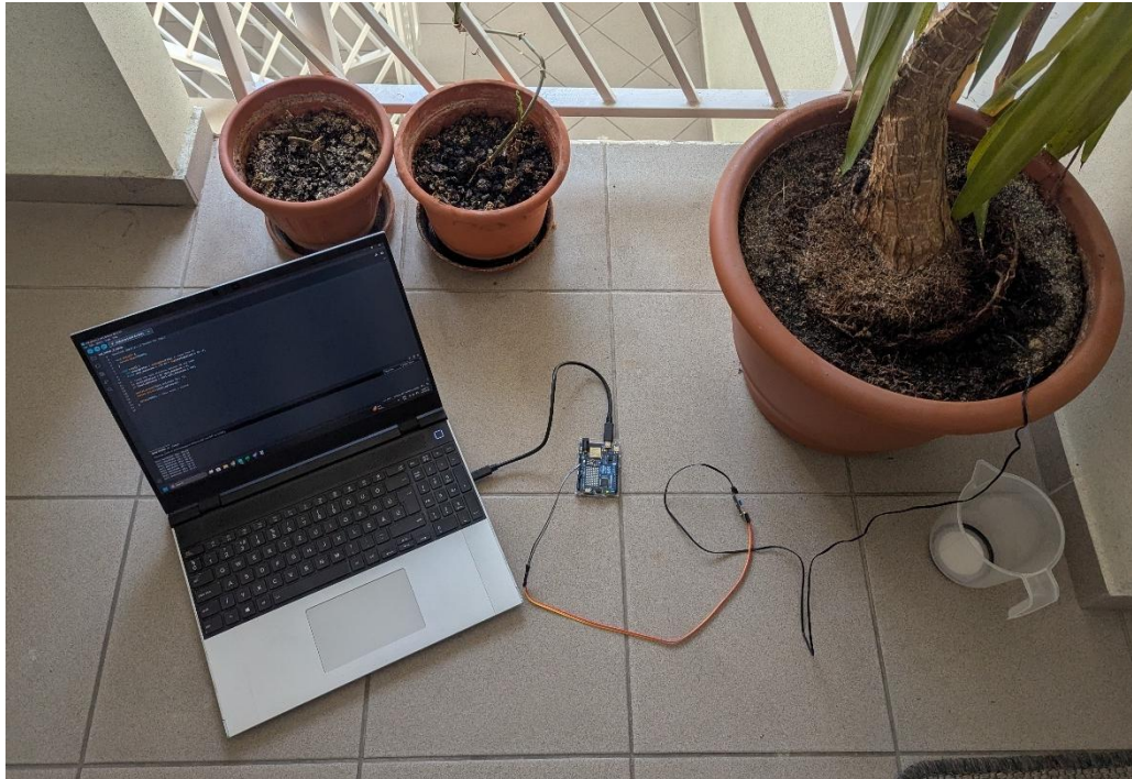
44. ábra: A kalibrált szenzor tesztelése
