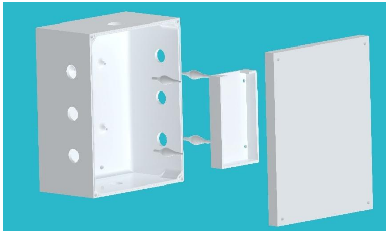
39. ábra: A development board és GSM modul új háza
