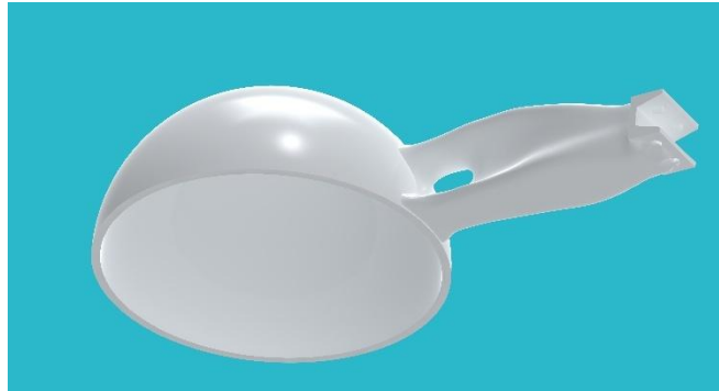
28. ábra: A generatív tervezéssel készített kanál
