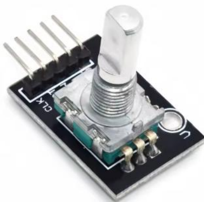
16. ábra: Egyszerű forgójeladó Forrás: https://www.aliexpress.com
