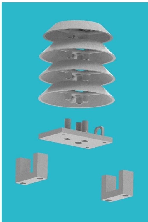
23. ábra: A hőmérséklet, páratartalom és légnyomásmérő összeállítása
