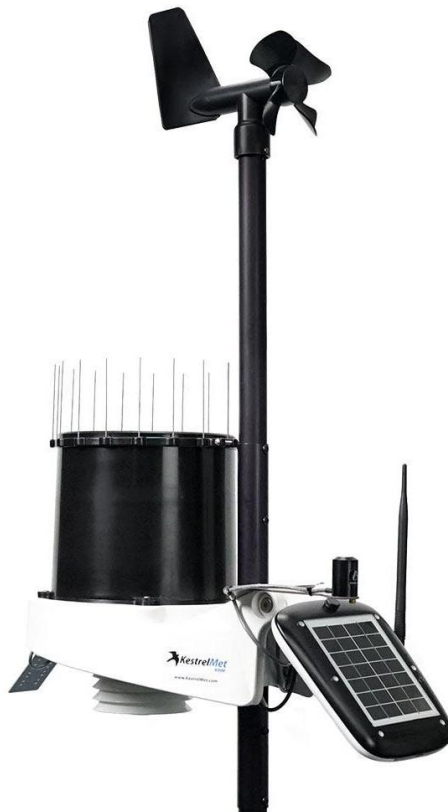
12. ábra: Az Ambient Weather KestrelMet 6000 AG állomás Forrás: https://kestrelmet.com
