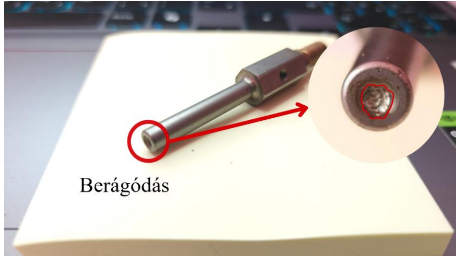
5.18 ábra Az alakító tüske berágódása 500 üzemóra után (CrN bevonattal)
