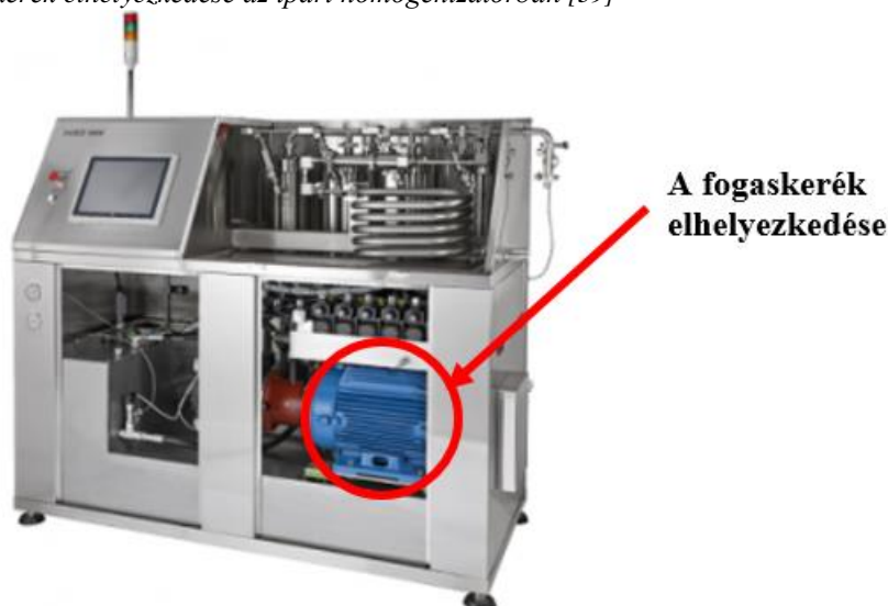
4.1. ábra: A fogaskerék elhelyezkedése az ipari homogenizátorban [39]
