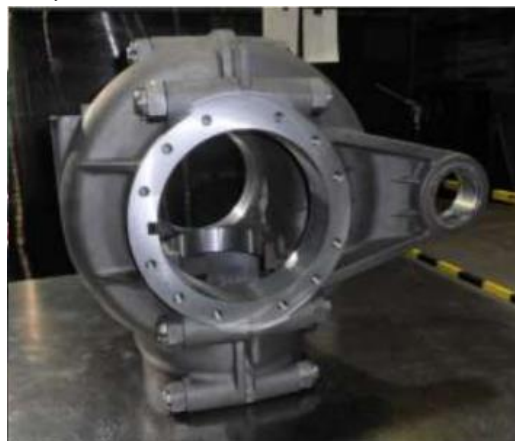
2.1. ábra: A cég által gyártott szivattyúház [29]
