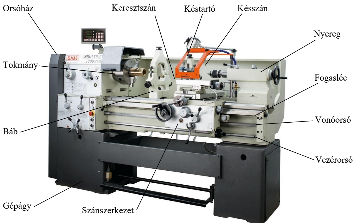
3. ábra: Az egyetemes csúcseszterga felépítése [29]
