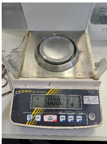
10. ábra: KERN PLJ 3500-2NM mérleg, amin a szárazanyagtartalmat mértem vissza (Forrás: saját kép)
