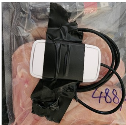
5. ábra: Efento Wireless Temperature Logger with External Probe (Forrás: saját kép)
