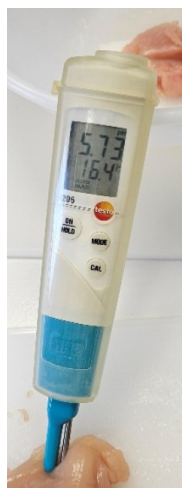
9. ábra: Testo 206 típusú kézi pH-mérő, ami hőmérsékletet is mér (Forrás: saját kép)
