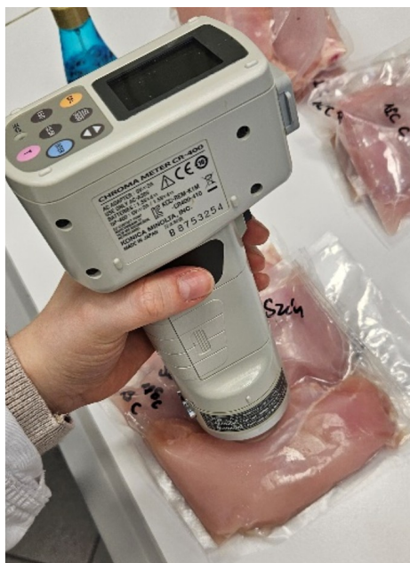
8. ábra: A színmérés a Minolta CR-400 Chroma Meter készülékkel történt (Forrás: saját kép)
