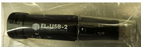
4. ábra: Lascar EL-USB-2 USB Temperature & Humidity Data Logger (Forrás: saját kép)
