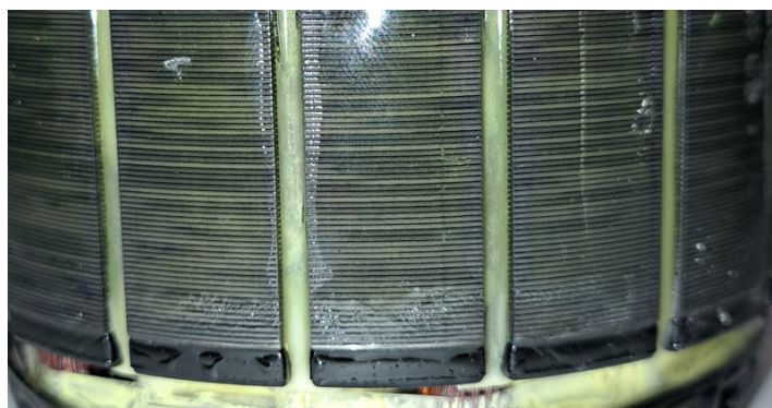
4.3 ábra Megfolyt, kikeményedett lakkréteg felnagyítva
