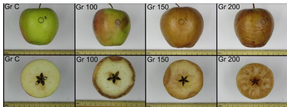
5. ábra: A nyomás hatására bekövetkező színváltozások (GrC - kontroll, Gr100 – 100 MPa, Gr150 – 150 MPa, Gr200 – 200 MPa)
