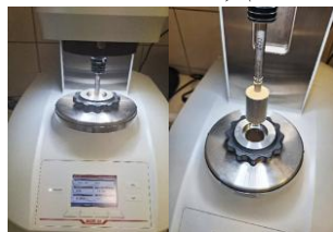
6. ábra. MCR 92 reométer (Anton Paar, Graz, Ausztria) (Forrás: saját fénykép)
