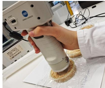
5. ábra. Konica Minolta CR-400 színmérő készülék (Forrás: saját fénykép)
