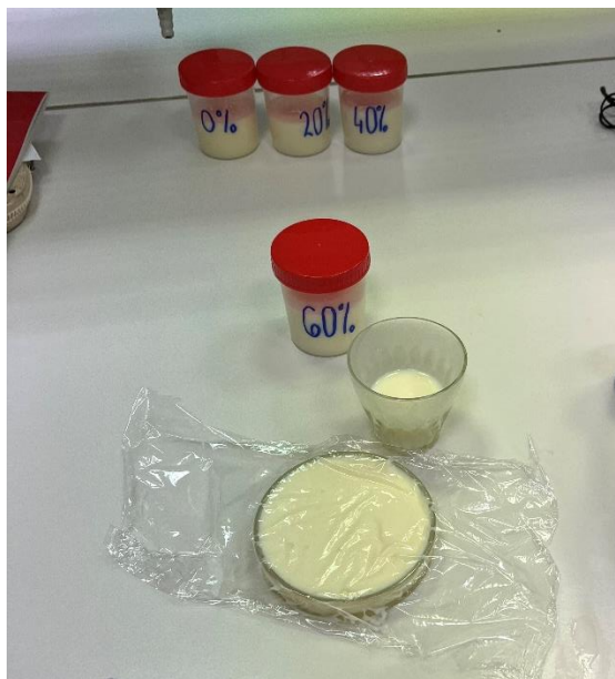
3. ábra: fagylaltminta színmérése petri-csészében, áttetsző fólián keresztül (forrás: saját szerkesztés)
