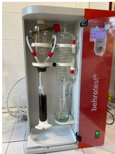
10. ábra: behr distillation unit S2 (saját forrás).
