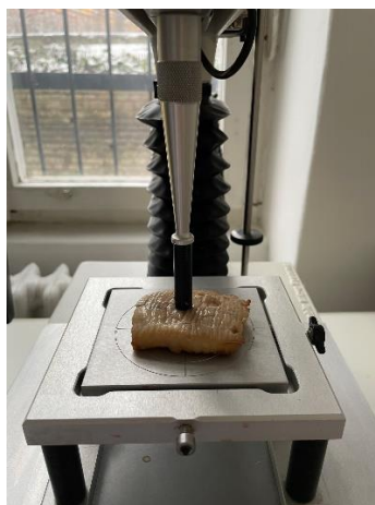
9. ábra: Sült hal keménység mérés, TA.XT.plus Texture Analyser mérőműszerrel (saját forrás).
