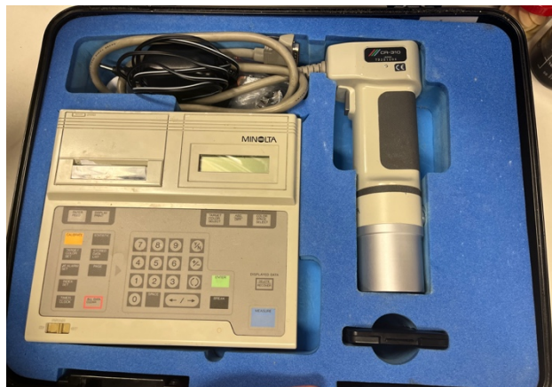
ábra 2 Minolta CR-310 színmérő készülék (Forrás: saját munka)
