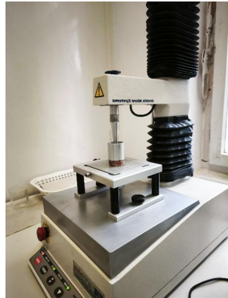
8. ábra - TA.XT Plus állománymérő berendezés a TPA mérés közben. forrás: Saját munka
