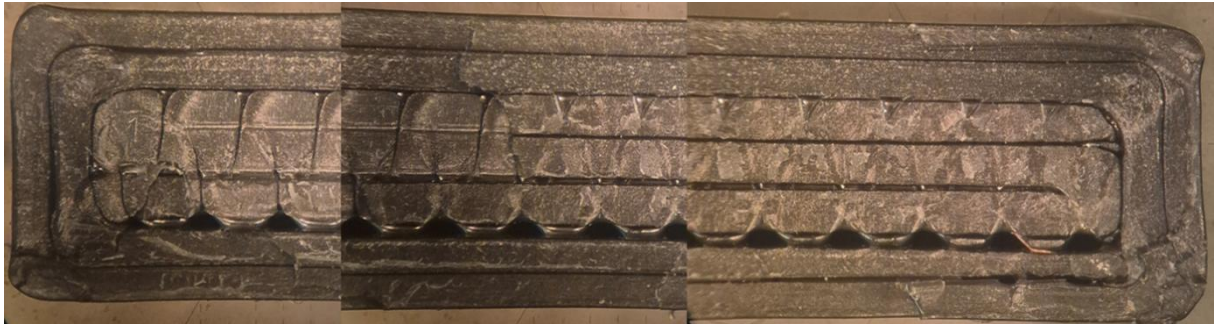
3.11. ábra Mikroszkopikus vizsgálat alapján kapott felülnézeti kép egy réteg felépüléséről
