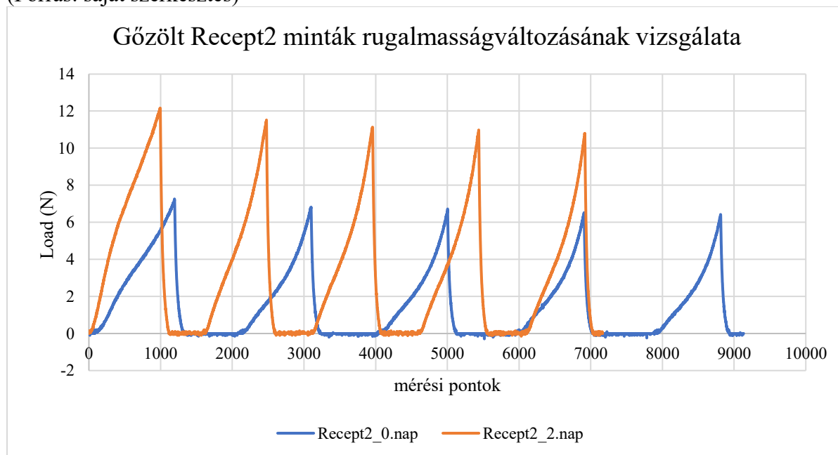
5. ábra: Gőzölt Recept2 minták rugalmasságváltozás vizsgálata (Forrás: saját szerkesztés)
