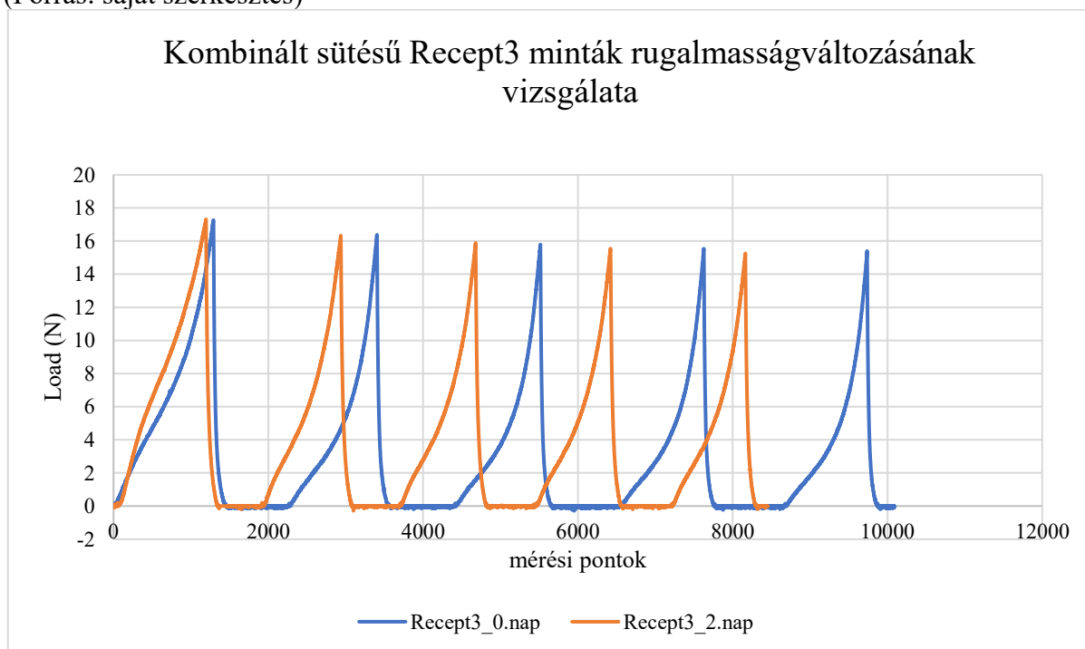
7. ábra: Kombinált eljárású Recept3 minták rugalmasságváltozásának vizsgálata (Forrás: saját szerkesztés)
