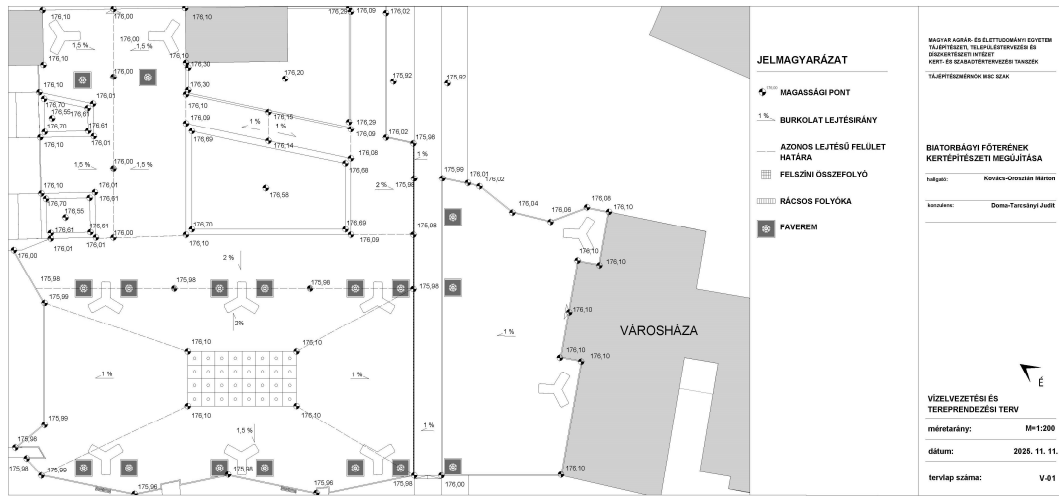
28. Ábra: Tereprendezési és vízvezetési terv (Forrás: saját ábra, alaptérkép: geodéziai felmérés, lásd V-01 tervlap)
