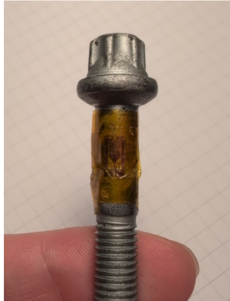
18. ábra: A csavarszárra felragasztott nyúlásmérő bélyeg
