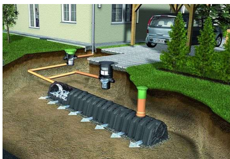
16. ábra Szikkasztóalagút autóbeálló alatt (Forrás: http12 )
