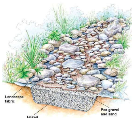
14. ábra Esőkert be/kifolyó felépítése (Forrás: http10 )
