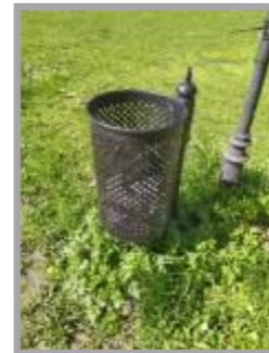
csőszlopos hulladékgyűjtő: 36 literes, acélső tartóoszlop tűzhorganyozás után porfestett, 1 mm-es perforált acéllemez edény csikkeinyomóval, tűzhorganyozás után porfestett
