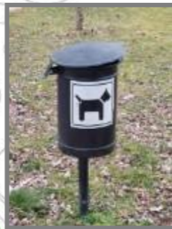
kutyaürülék tartó: acélső tartóoszlop tűzhorganyozás után porfestett, fedett
