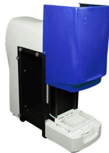
4. ÁBRA A VISELKEDÉSVIZSGÁLAT ELVÉGZÉSÉRE SZOLGÁLÓ KÉSZÜLÉK (VIEWPOINT ZEBRALAB, ZEBRABOX) (FORRÁS: SAJÁT KÉSZÍTÉSŰ ÁBRA)
