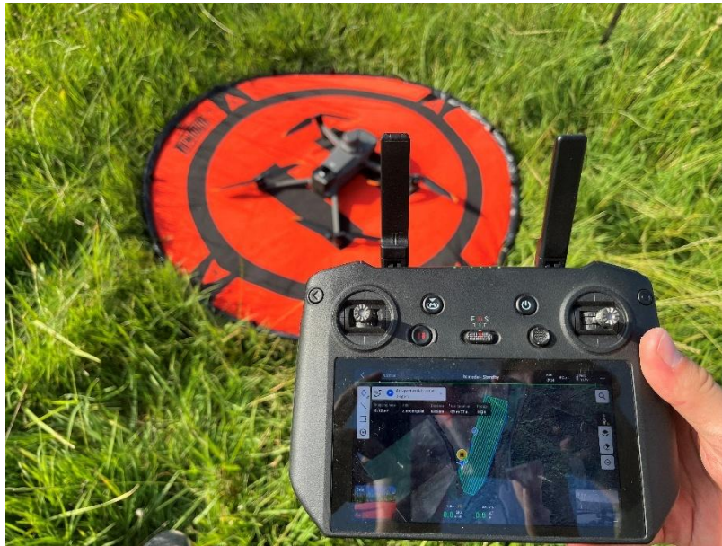
3. kép Repülés előtt készült kép a drónról és a távirányítójáról, amelyen látható a DJI Pilot 2 alkalmazás és a drón előre meghatározott útvonala; saját kép
