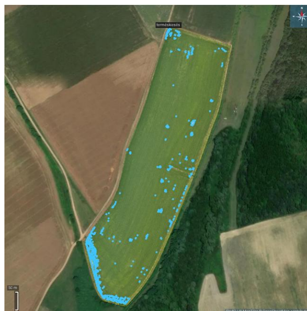
10. kép Terméskiesés becslése Pix4DFields-ben, a kiesett területek helyei kék színnel jelölve, saját felmérés
