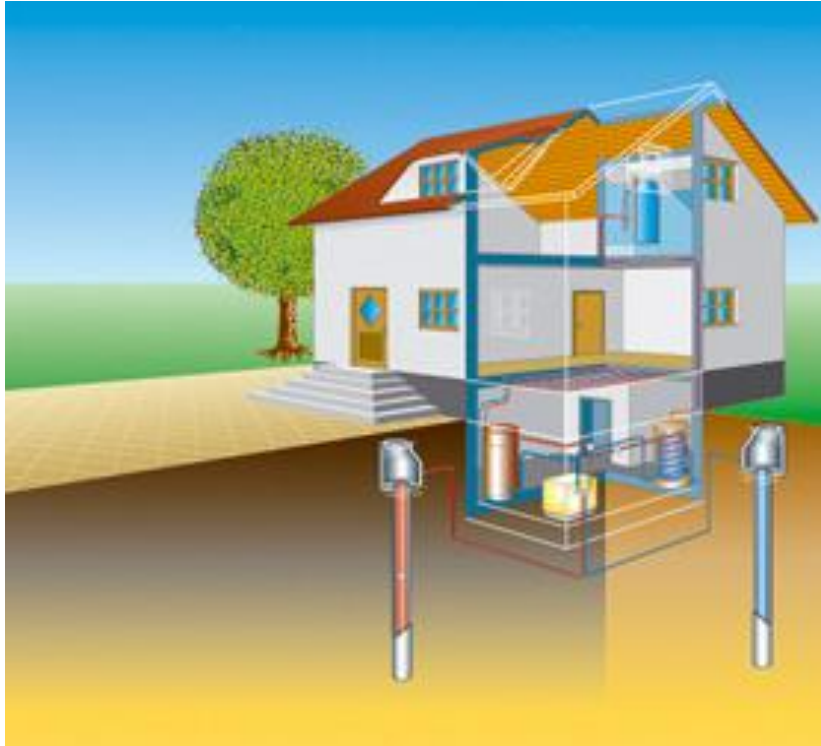
7. ábra: Talajszondás hőszivattyú (Forrás: geokomfort.hu)
