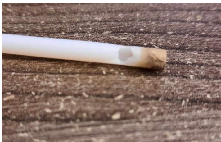
10.2. ábra, silány minőségű megégett tefloncső [saját ábra]
