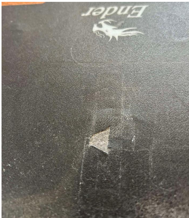
10.1. ábra, hajtogatásból sérült nyomtatótálca [saját ábra]
