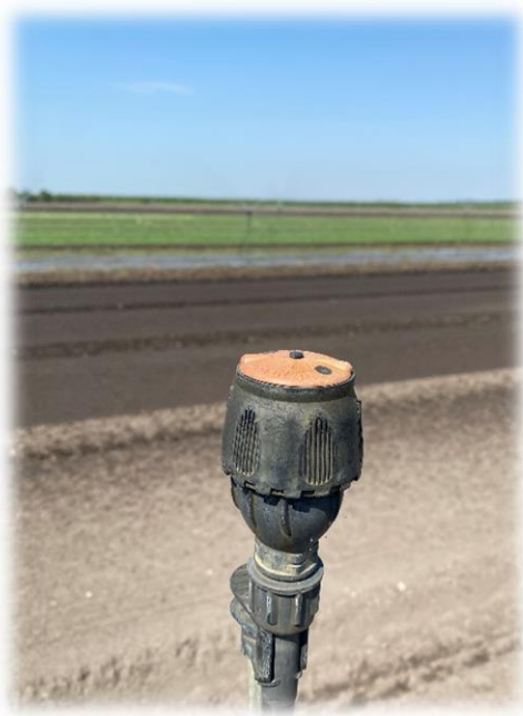
21. ábra 550l/h Netafim mikroszóráfej (fotó: szerző)
