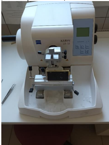
8. ábra, kézi vezérlésű mikrotóm (Forrás: saját szerkesztés)
