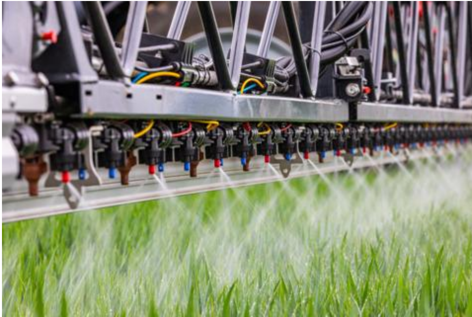
3. ábra Szakaszevezérlés működés közben, Horsch 2024, Forrás: Horsch, http3
