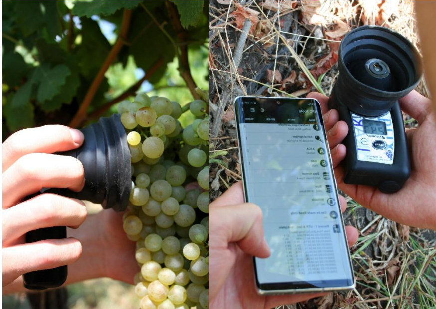
6. ábra Brix° mérés az adatokat kinyerése NFC segítségével (saját fénykép)
