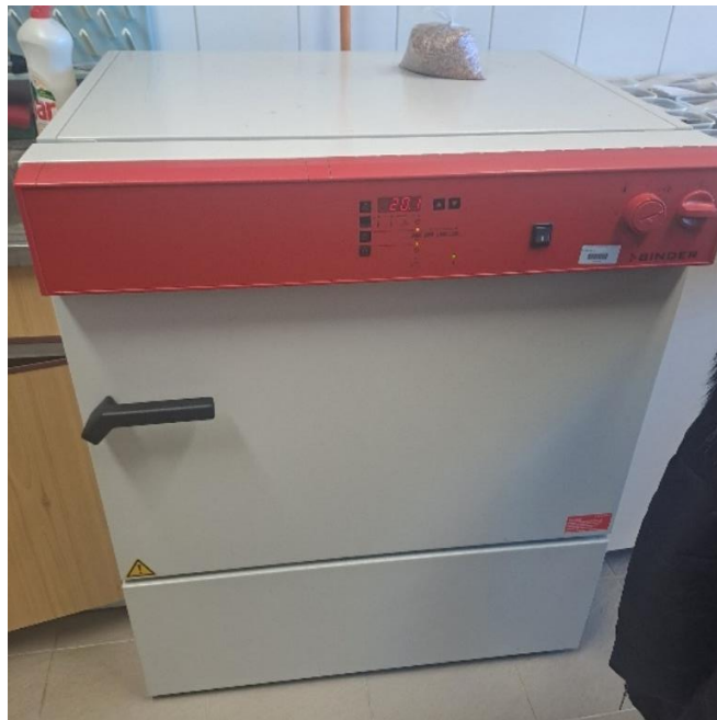
10. ábra Binder típusú hűtő-fűtő termosztát a MATE Georgikon Campus Bioinnovációs Központ Herbológiai Laboratóriumában
