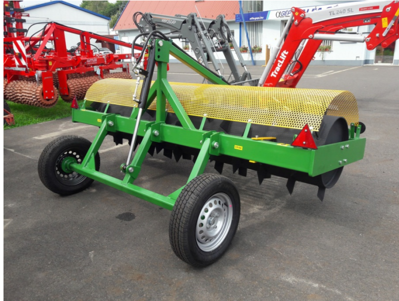
4. ábra, Gyepszellőztető henger (http8)
