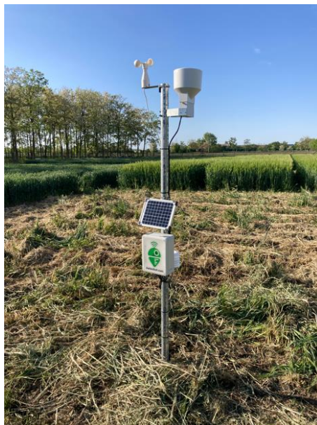
8. ábra az időjárási adatokat rögzítő Meteobot mérőállomás
