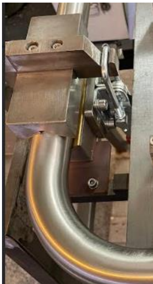
5-35. ábra. Gyártásban üzemelő prizmás szorító
