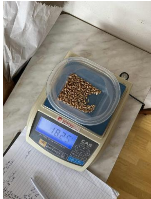
9.ábra Kalásonkénti szemtömeg mérése
